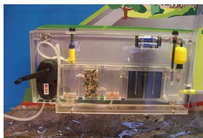
Mehrstufige Wasseraufbereitung beim Seewasserwerk
