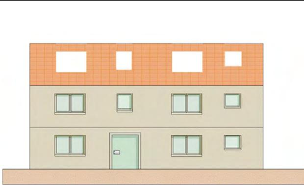
Das dazukommende Stockwerk kann konventionell gemauert, oder in Leichtbauweise erstellt werden. Auch eine Attika mit Terrasse ist möglich. Hier wird als Beispiel vorerst die Variante mit Aufmauerung eines vollständigen Geschosses aufgezeigt. AK neues Mauerwerk ist bündig zu AK bestehendes Mauerwerk resp. genau genommen AK Verputz.
