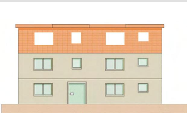
Der Dachabschluss wird mit vorfabrizierten Flachdachelementen (R8 Module) erstellt. Die Flachdachelemente können auch erst nach der Fassade angebracht werden (besser aus Sicht Lüftungsleitungen verbinden zwischen Fassade und Dach)
