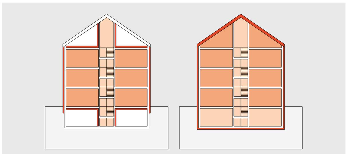
tig grosse Abwicklung, komplizierte Bauteilanschlüsse und Wärmebrücken vermeiden (Abbildung 15).
