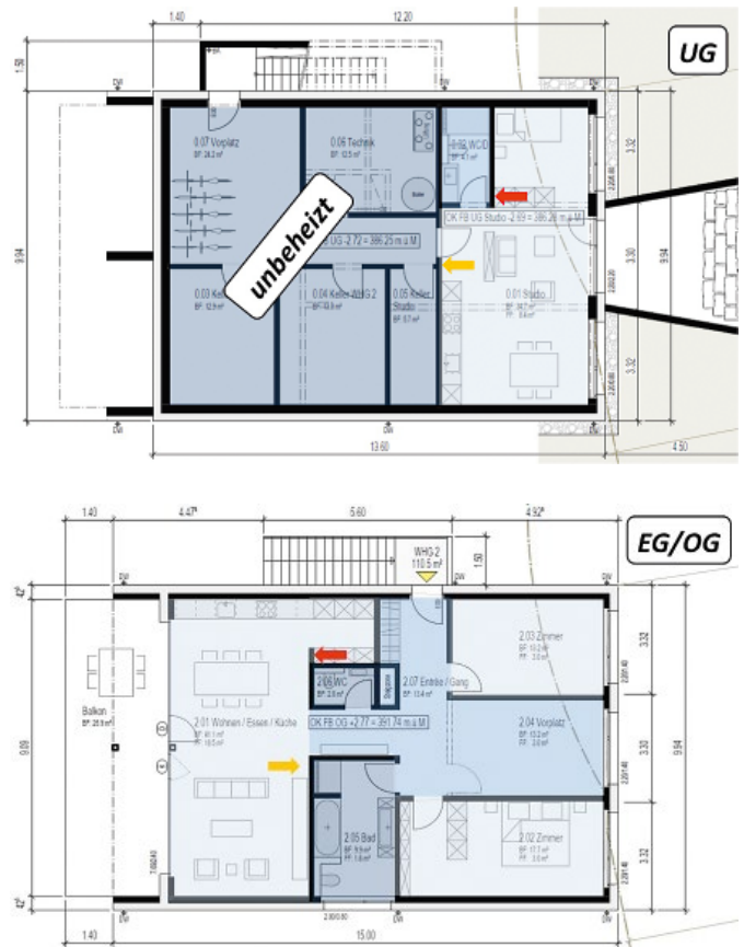
Bild 3. Aufteilung der thermischen Zonen; Lage der Temperaturfühler (rot) und Heizungsthermostate (orange) im Raum „Wohnen“
