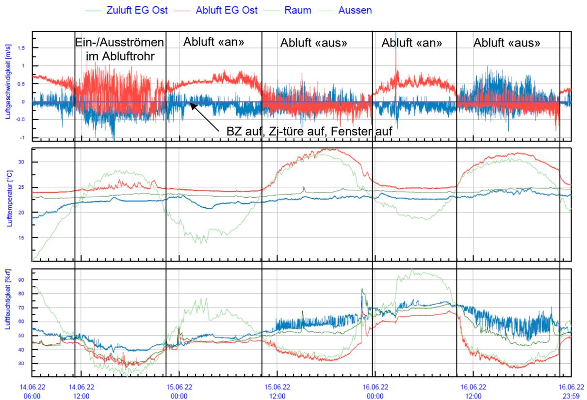
Abbildung 5 *Generelles Lüftungsverhalten in Abhängigkeit von der Temperaturdifferenz zwischen Bad und Umgebung. Während der gesamten Zeit ist die Badezimmertüre (BZ) geöffnet und mindestens in einem Zimmer sind das Fenster und die entsprechende Zimmertüre auf (Alles). Damit weist das Bad eine Verbindung zur Umgebungsluft auf.*
