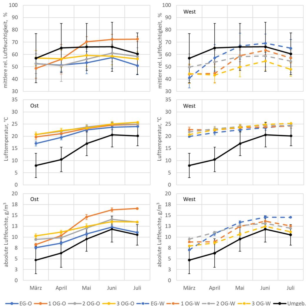
Abbildung 3 Monatliche Mittelwerte und einfache Standardabweichung der rel. Luftfeuchtigkeit (oben), Lufttemperaturen (mitte) und absoluten Feuchte (unten, berechnet aus den Monatswerten) in den Ost- und Westbädern und der Aussenluft.
