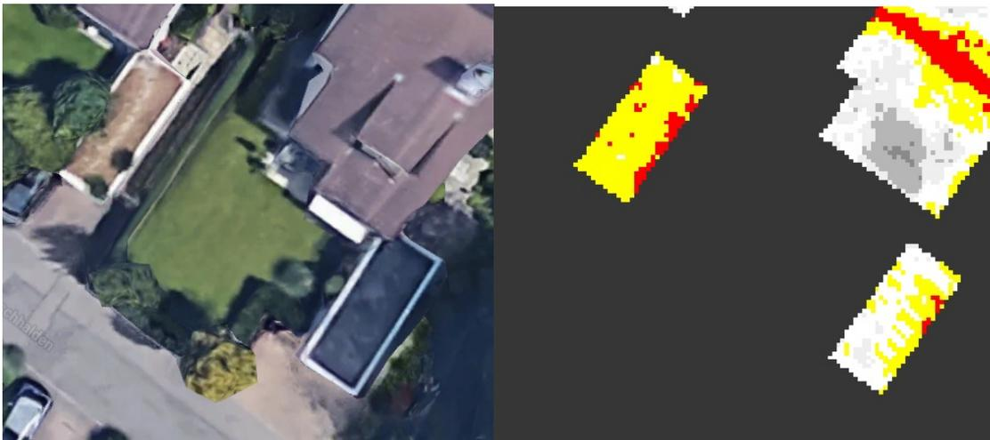
**Abbildung 18: automatische pixelbasierte Klassifikation zur Detektion von Hot-spots auf Dächern (Geomatik-Seminar-Arbeit). Links: Google-Maps, Rechts: klassifiziertes Thermalbild**
