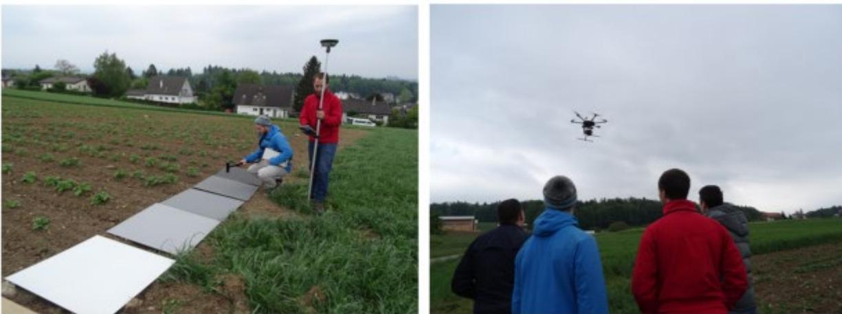
**Abbildung 17: Passpunktmessung, hyperspektrale Referenzmessungen und Befliegung (Headwall) auf einem Kartoffel-feldes bei Riedholz (SO) mit Geomatik-Studierenden**
