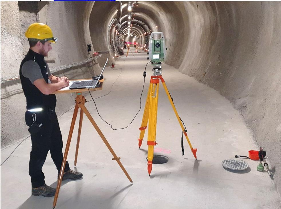
**Abbildung 10: Präzisions-Tachymetrie mit TM30 und der Software PCTRI von swisstopo in der neuen Galerie 18**
