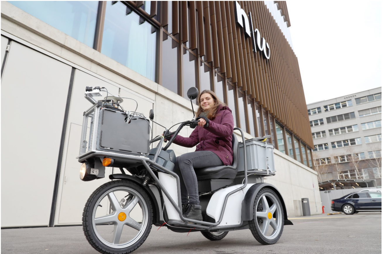
Abbildung 8: Neues elektrisch betriebenes Mobile Mapping Forschungsfahrzeug des IGEO mit einem experimentellen Messaufbau für das mobile Parkplatzmonitoring (Projekt BiPaMo und Masterthesis Jasmin Frey)
