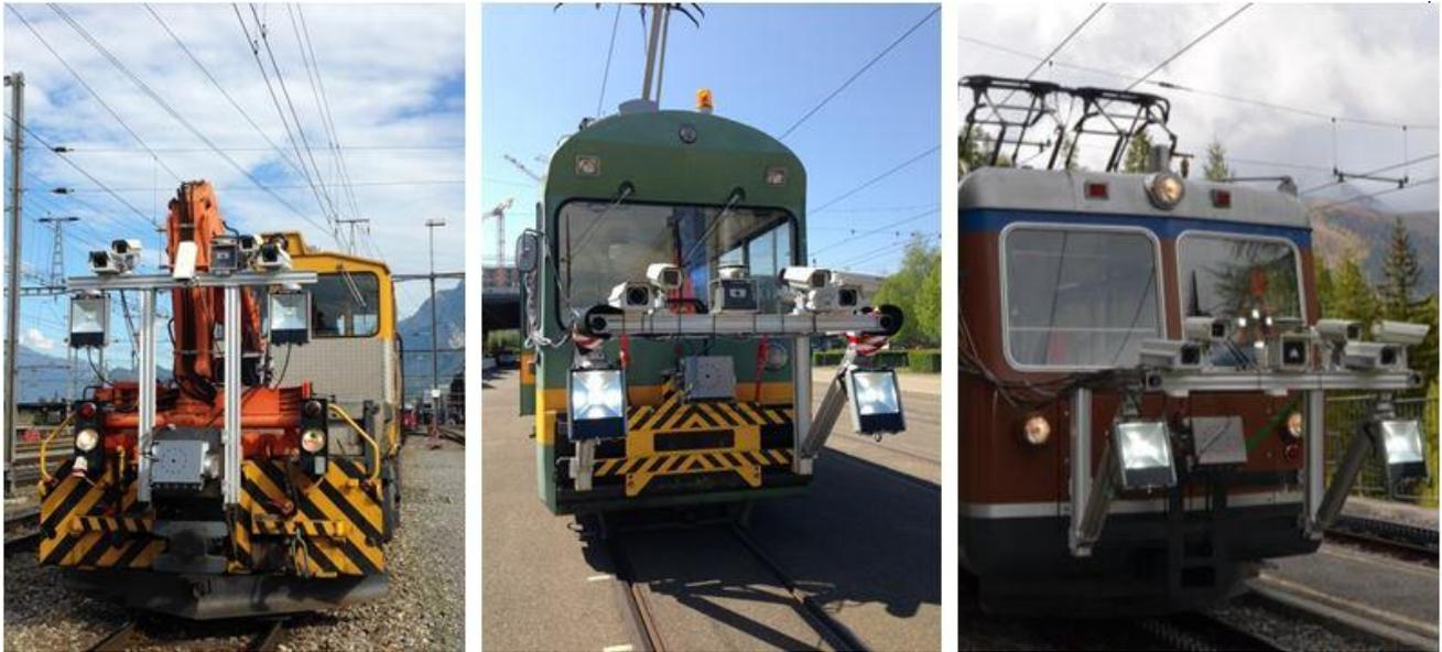
**Abbildung 9: Der Rail Track Scanner aus dem TQual-Projekt im Einsatz bei der Rhätischen Bahn, den Verkehrs-betrieben Zürich und der Gornergratbahn**
