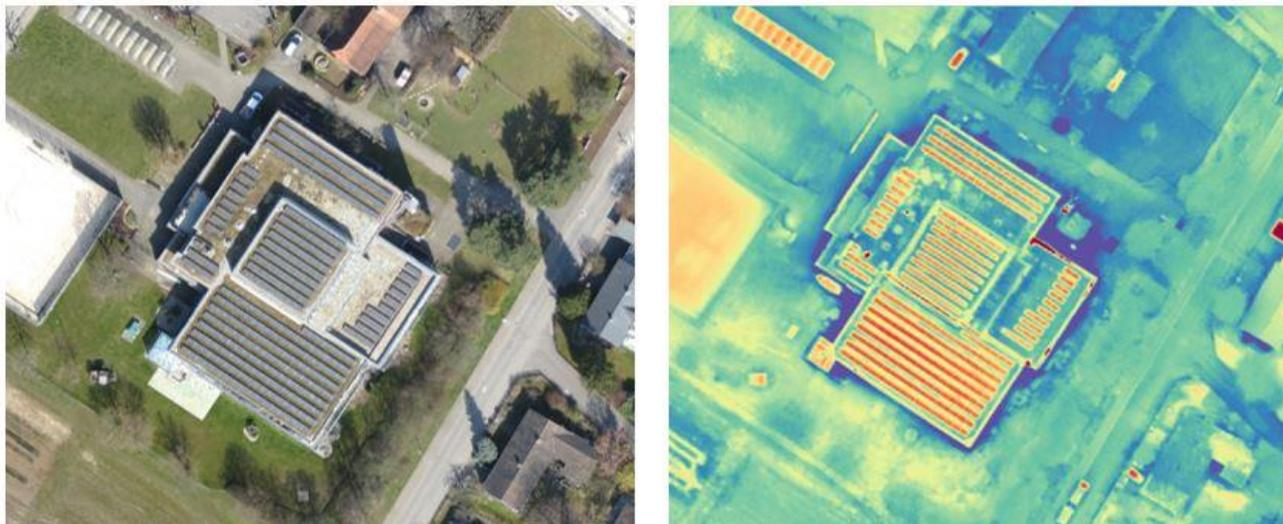
Abbildung 20: rechts: Thermales Drohnenbild von Gebäude links
