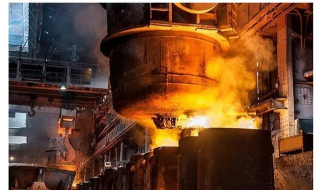
Schmelztemperatur Stahl bei 1500°C
