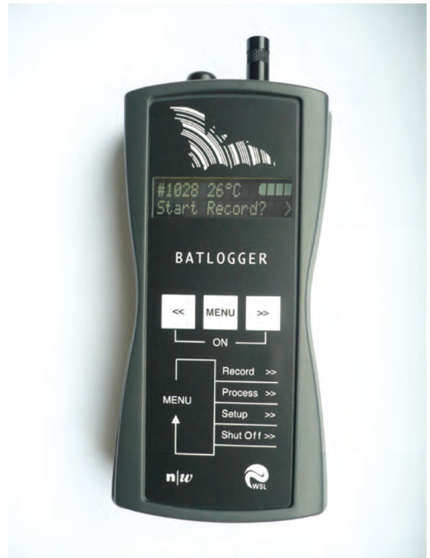
Abbildung 1: Der "BATLOGGER" ist ein serienreifes hightech Produkt für die Aufzeichnung von Fledermausrufen. Auf der Stirnseite ist rechts das steckbare Ultraschallmikrophon mit integriertem Temperatursensor und links die GPS-Antenne sichtbar. WSL und FHNW wurden auf der Bedienfolie und im Manual des BATLOGGERS "verewigt".
