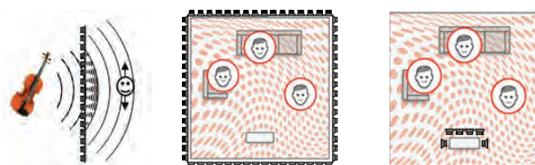
Bild 2: a) Erzeugung Wellenfeld b) Wellenfeld-Erzeugung durch aussenliegende Lautsprecher c) Umkehrung: Lautsprecher-Array innerhalb Hörzone
