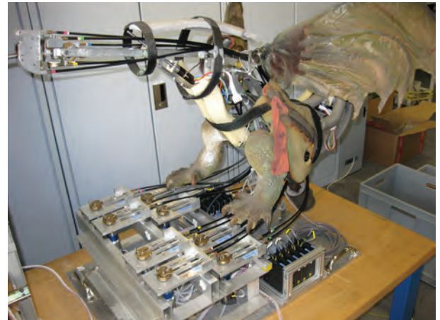
Abbildung 3: Das Innere des Fauchi, vorne die Seilzug-Antriebe und auf der Grundplatte links und rechts die Motormodule.
