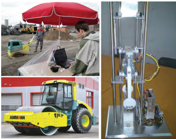
Abbildung 5: das Prinzip der autoparametrischen Resonanz ist eine skalierbare Technologie - sie kann für Maschinen mit 20'000 kg (Walzenzug), 500 kg und auch 5 kg angewendet bzw. nachgewiesen werden. Das 5 kg Modell wurde durch die beiden Studierenden Niederberger und Marending 2009/2010 aufgebaut und die nichtlineare Dynamik nachgewiesen.
