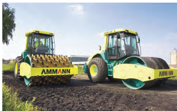
Abbildung 1: Typische dynamische Bodenverdichtungsgeräte, auf welchen die neue Messmethode zur arbeitsintegrierten Messung der Bodensteifigkeit als Mass für die erreichte Verdichtung angewendet wird.
