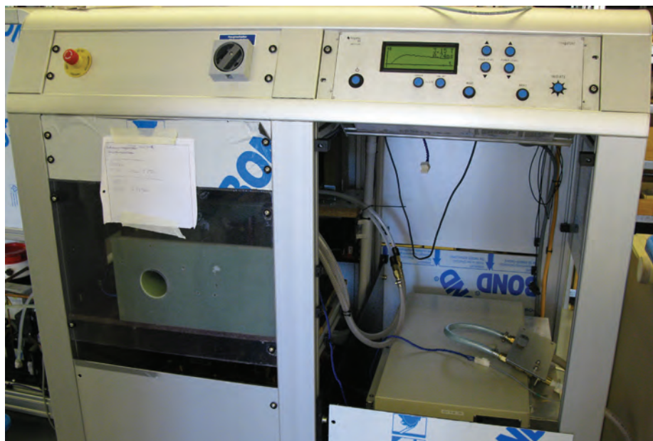
Abbildung 1: In diesem Pulsmagnetisiergerät, in dem üblicherweise Permanentmagnete aufmagnetisiert werden, wurden die Wasserproben den Pulsmagnetfeldern bis zu 5 Tesla ausgesetzt und dann die mögliche Beeinflussung auf die Leitfähigkeit kontrolliert.
