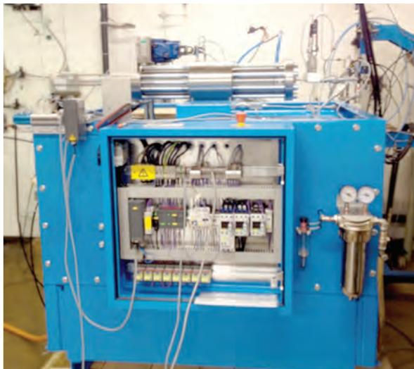
Abbildung 1: Hochdruckwasserstrahlschneidaggregat im Prüfstand bei Jet Cut GmbH mit Sensorik zur Modellvalidation
