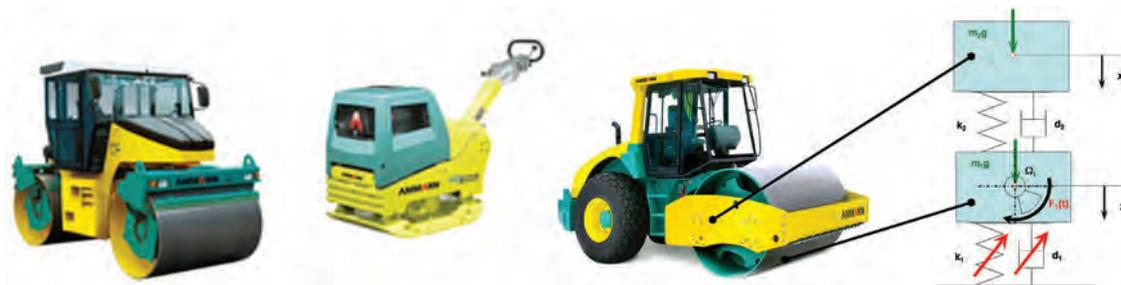
Abbildung 1: Beispiele von Verdichtungsmaschinen, links ein Walzenzug, rechts eine Vibrationsplatte, daneben das Zweimassenschwingermodell für einen Walzenzug
