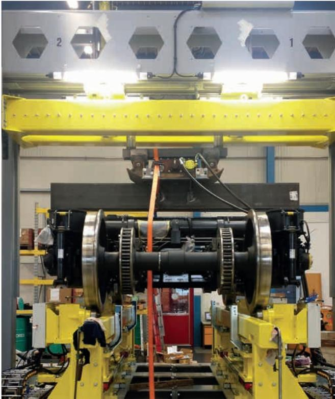
Abbildung 5: Messaufbau Stadler KISS Drehgestell
