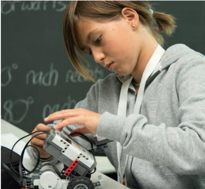
aus einem Styroporblock aussägen. Dazu «teachen» sie dem Roboter die Eckpunkte ihrer Figur und erstellen danach ein Programm, mit dem sie die Eckpunkte über Geraden oder Kreissegmente abfahren. Würde man alle ausgeschnittenen Figuren und Objekte in eine Kiste werfen, könnte man sie sehr leicht den Knaben oder Mädchen zuordnen. Wer macht wohl die Styroporherzen und Blumen, wer die Autos und Panzer?
