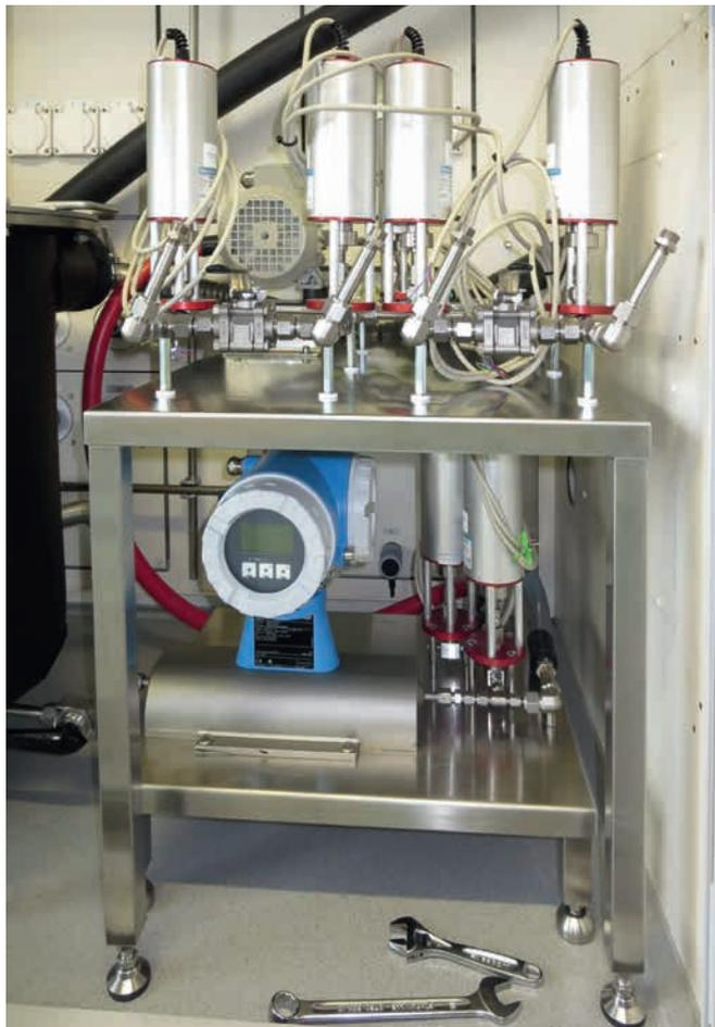
Abbildung 5: Kompakte Realisierung der Mischventile.
