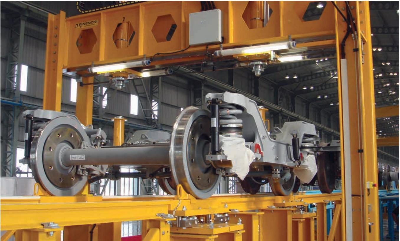
Abbildung 1: Drehgestellprüfstand der Firma Nencki
