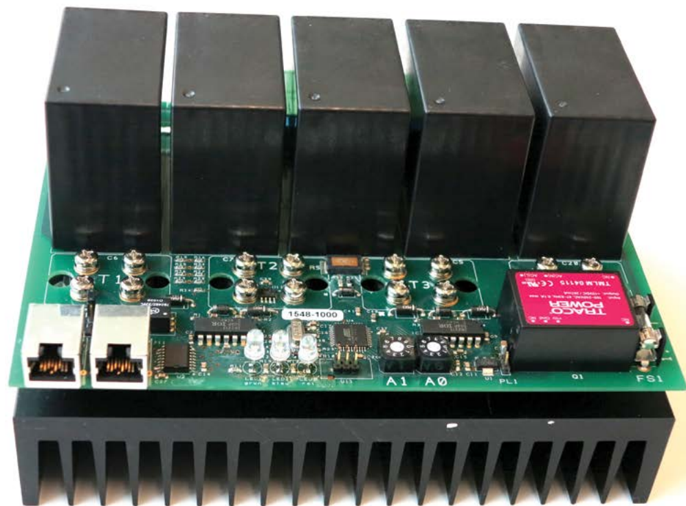
Abbildung 1 zeigt das Innere der Steuerung. Alle sechs Leistungshalbleiter sind im gleichen Gehäusotyp direkt auf den Kühlkörper geschraubt und die Halbleiter wiederum dienen als Träger der Steuerplatine.
