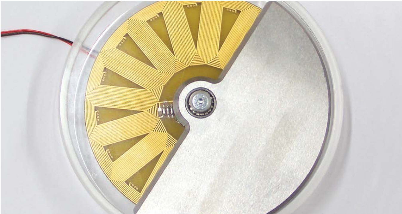
Abbildung 1 zeigt schematisch das 1. Funktionsmuster eines Exzentergenerators, der mit einem pendelnden Rotor (aussen) und einem Stator (innen) elektromagnetisch Energie aus Kippbewegungen und Linearbeschleunigungen erzeugt.
