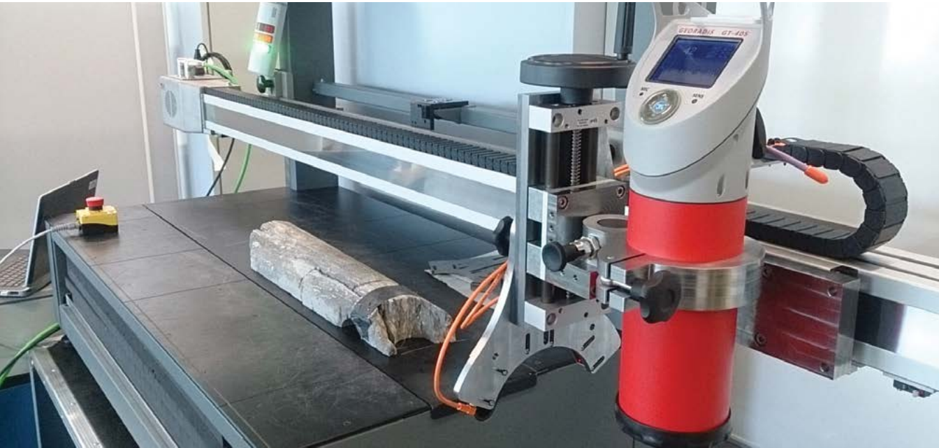
Abbildung 1: Messgerät zur automatisierten Oberflächen- und Strahlungswertemessung von Bohrkernen
