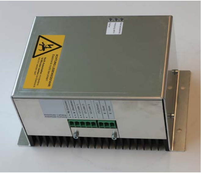
Abbildung 2 zeigt die Einbau fertige Steuerung aus Kühlkörper und Alu-Haube. Das Metallgehäuse wurde vor allem auch aus EMV-Gründen gewählt. Kühlkörper und Haube sind vorschriftsgemäss von den Polleibern getrennt. Die gesamte interne Messung und Steuerung arbeitet auf Polleiterpotenzial.
