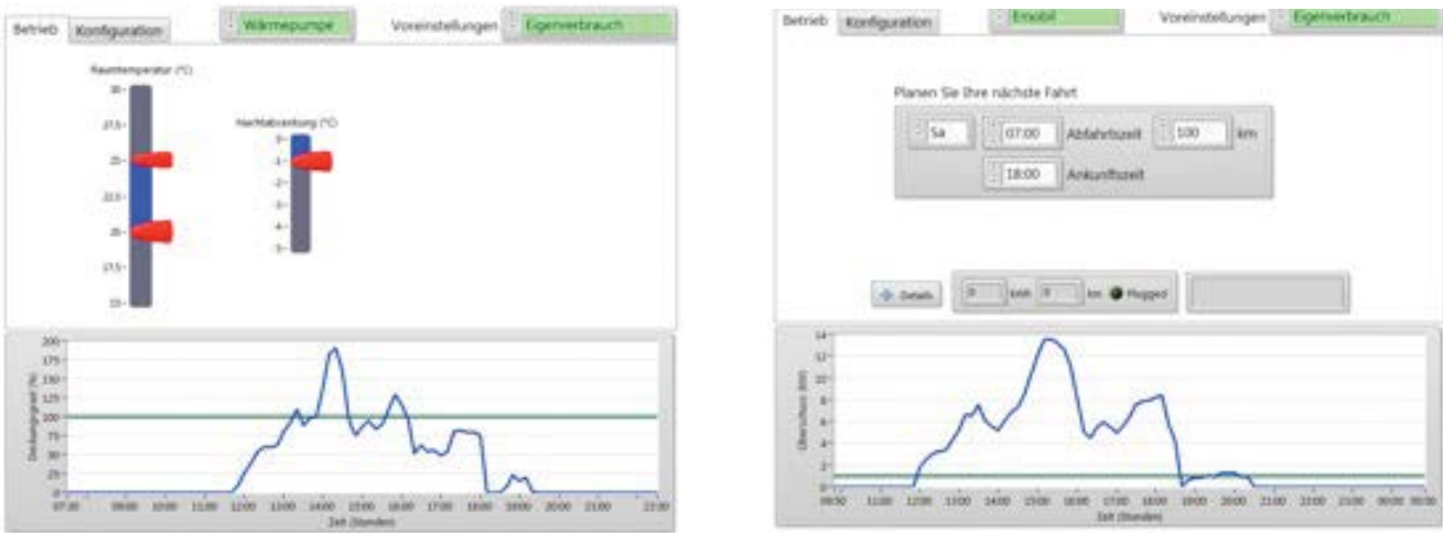
Abbildung 4: Eigenverbrauchs-Optimierung für die Wärmepumpe (links) und das Elektromobil (rechts). Vorgabe des Raumtemperaturbereichs in °C (links) bzw. Eingabe der nächsten geplanten Fahrt mit dem Elektromobil (rechts). Adaptiv berechneter Schwellwert (grüne Linie) und Verlauf des Deckungsgrades (blaue Kurve).
