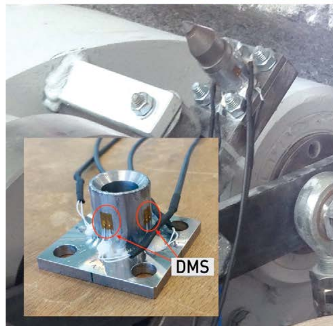
Abbildung 4: Aufbau des Validierungsversuchs mit Meissel, DMS und Datenerfassungshardware
