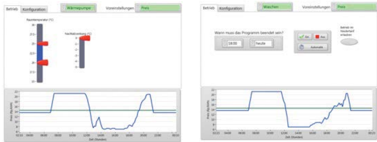
Abbildung 5: Kosten-Optimierung für die Wärmepumpe (links) und den Waschvorgang (rechts). Vorgabe des Raumtemperaturbereichs in °C (links) bzw. Eingabe des Zeitpunktes, wann die Wäsche gewaschen sein soll (rechts). Adaptiv berechnete Preisschwelle (grüne Linie) und Verlauf des Preises (blaue Kurve).
