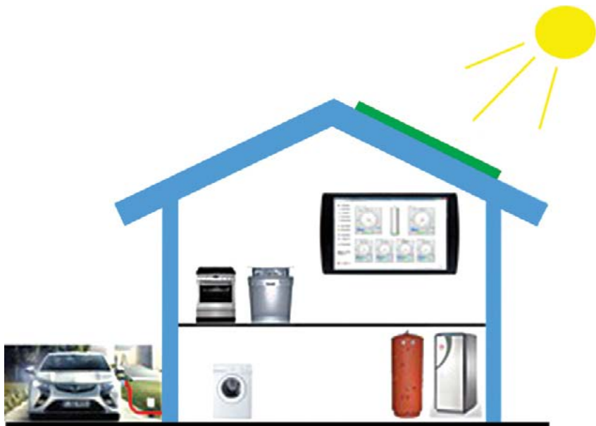
Abbildung 1: Gebäude mit Eigenverbrauchsmanager und Komponenten wie Photovoltaikanlage, Wärmepumpe, Brauchwarmwassererwärmer, Elektromobil (Plug-In-Hybrid) und Haushaltgeräten.
