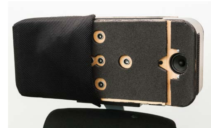
Abbildung 3: Einbau der Signalverarbeitung, Sensorik und Aktorik in der Kopfstütze des Funktionsmusters
