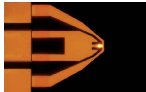
Abbildung 1c: Mikroskopbild eines SwissLitho Cantilevers mit glühender Spitze
