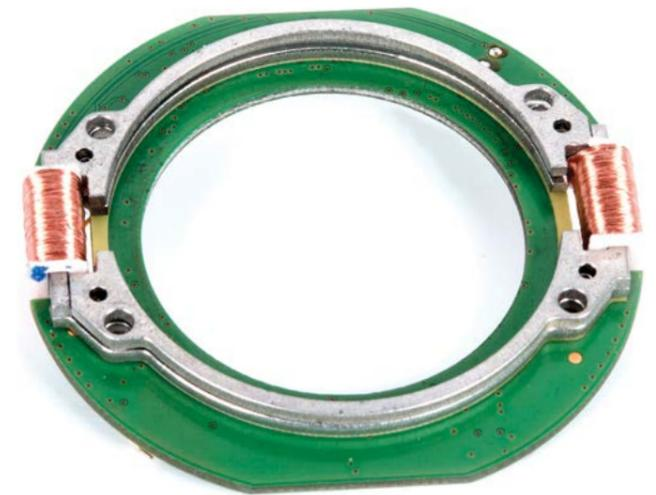
Abbildung 2: Elektronikseite des Statorbereichs des Generators mit 2 Spulen für die Energiegewinnung und die Drehrichtungserkennung.
