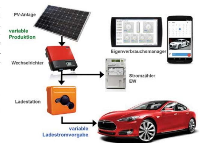
Abbildung 4: Heutige Lösung zum intelligenten Laden des Elektromobils mit variabler Stromvorgabe
