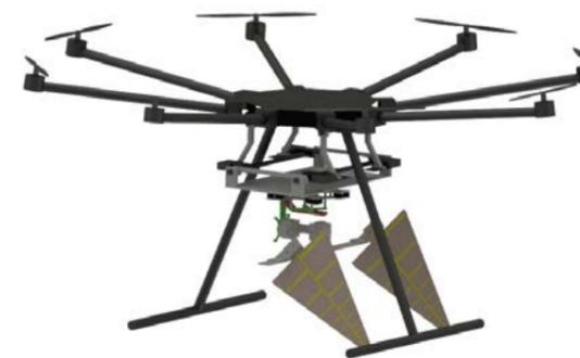
Abbildung 2: Mechanischer Aufbau des Flugsystems
