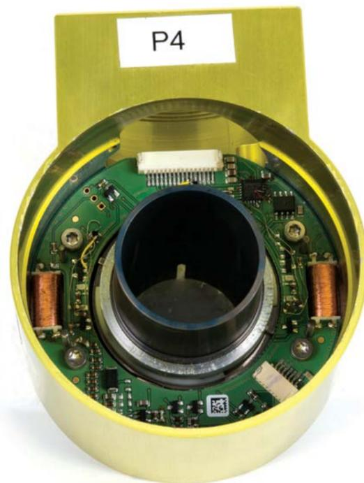
Abbildung 1: Mikrogenerator-Prototyp, eingebaut in das Winkelsensorgehäuse
