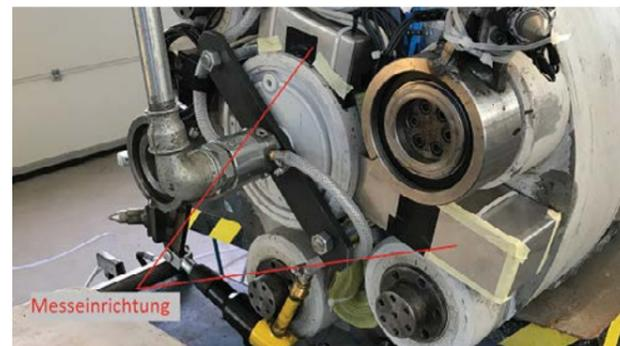
Abbildung 5: Versuchsaufbau mit zwei aktivierten Meisseln im Testbetrieb
