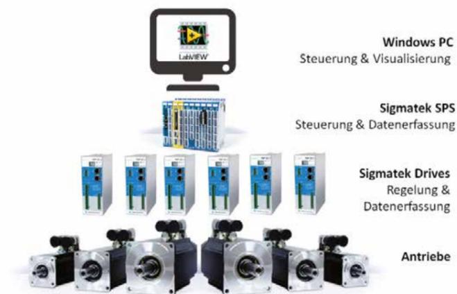
Abbildung 3: Systemüberblick der Steuerung und Regelung der automatisierten Falzbank.
