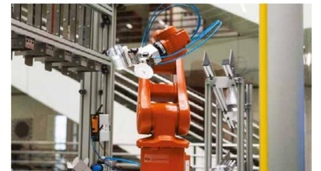
Abbildung 3: Der Roboter führt die Verpackungseinheit zum Magazin (oben: virtuell, unten: real).
