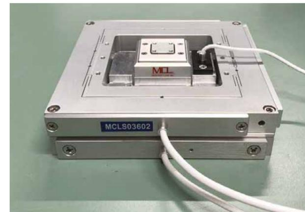
Abbildung 2: Piezopositionierer
