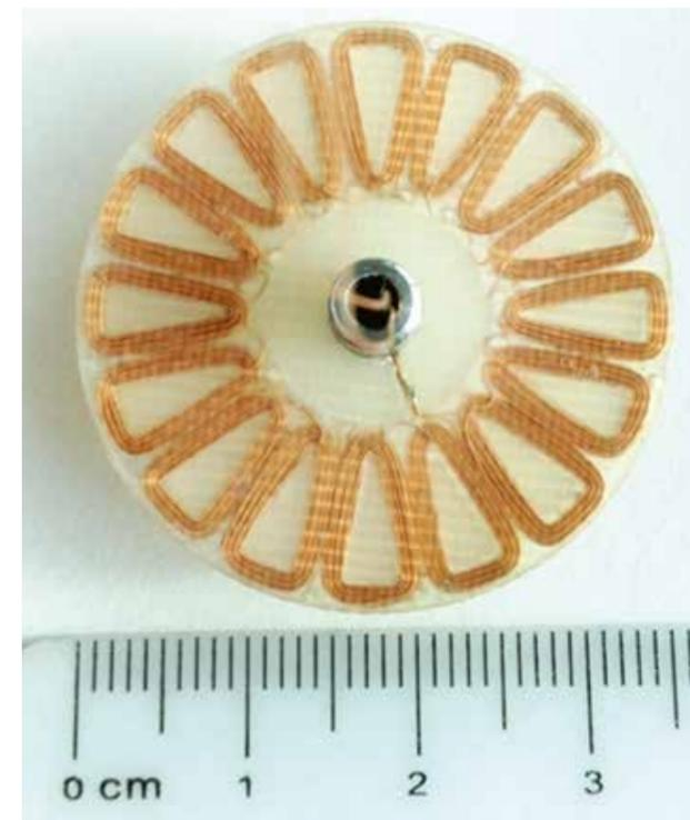
Abbildung 3: Stator-Drahtwicklung
