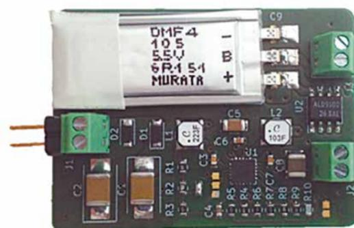
Abbildung 2: Elektronik zur Zwischenspeicherung der Energie
