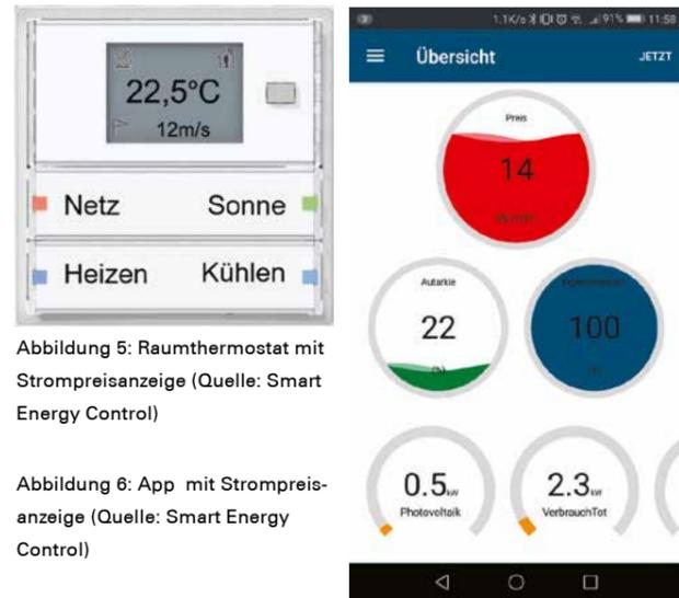
Abbildung 5: Raumthermostat mit Strompreisanzeige (Quelle: Smart Energy Control)
