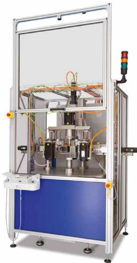
Abbildung 1: Elektrisch angetriebene Falzbank mit sechs Achsen, welche unabhängig parametrisiert und geregelt werden können, um den Falzprozess genauestens zu analysieren.
