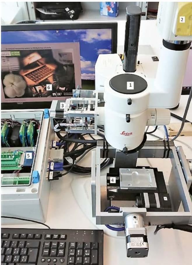
Abbildung 1: System-Komponenten: 1. Leica MZ6 Binokular mit Motorfokus (B) 2. Digital Video Kamera (A) 3. Motorzoom (C) 4. 4-Achsen Motortisch (D) 5. Steuerkasten 6. PC mit LabView
