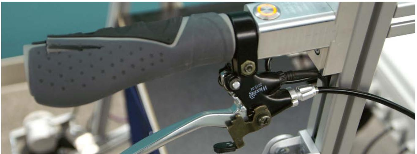
Abbildung 3: Griff mit Totmannschalter, Bremshebel und Drucktaster
