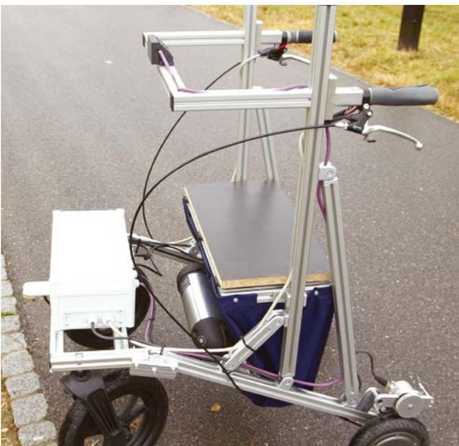
Abbildung 1: Funktionsmuster des elektrischen Rollators
