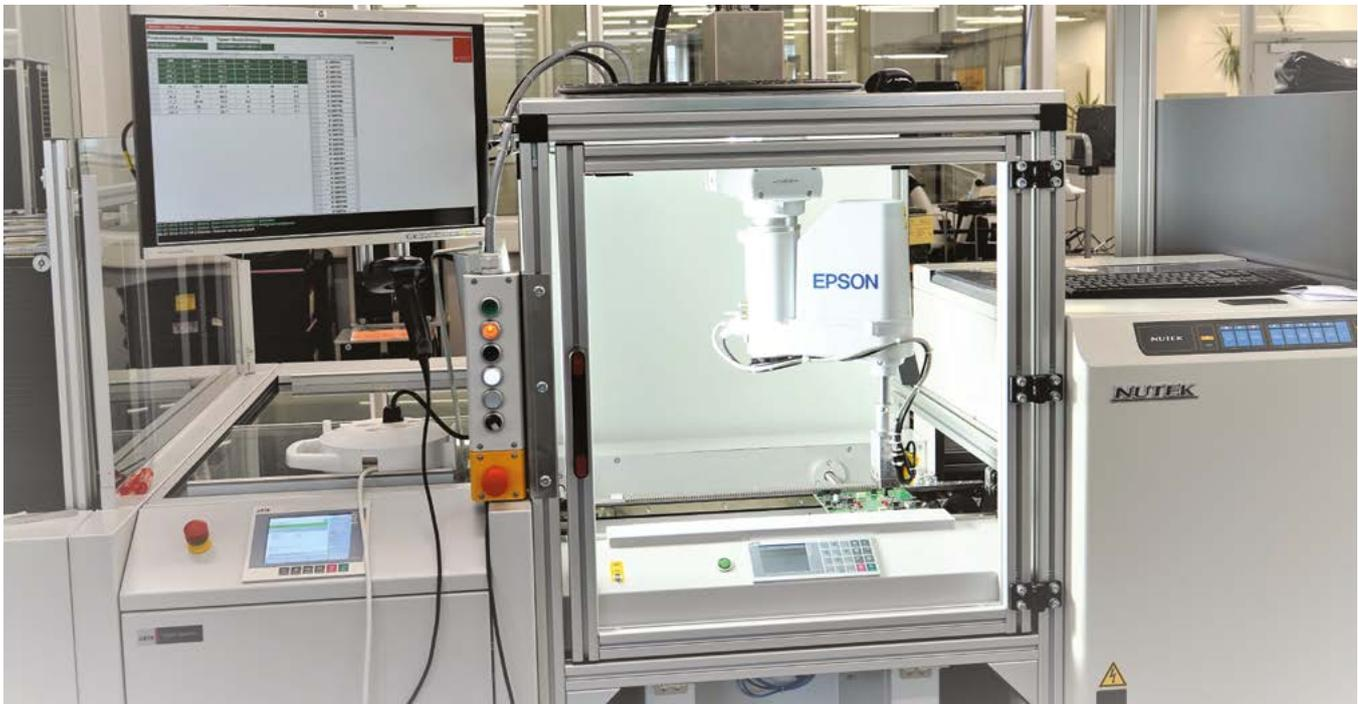
Abbildung 1: In die AOI-Linie integrierte Roboterzelle mit Bandmodul als Basis
