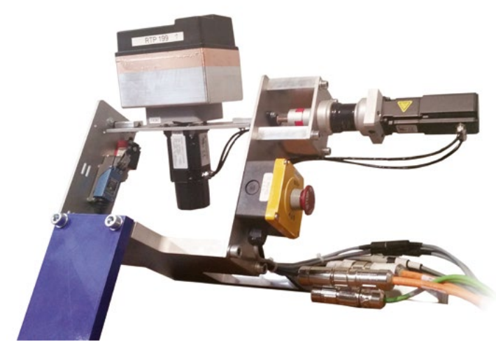
Abbildung 3: 3D-Messaufbau mit Positionierungs-Aktorik und Störsender
