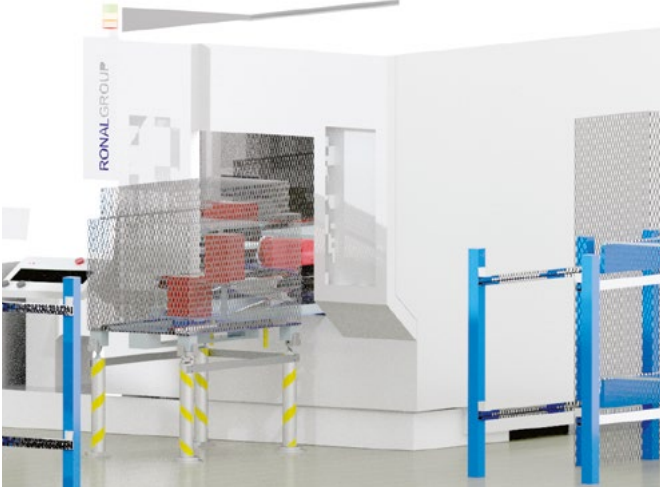
Abbildung 3: Mobiles Wechselmodul (MWM) vor CNC-Maschine zur Be-/Entladung eines Werkstücks
