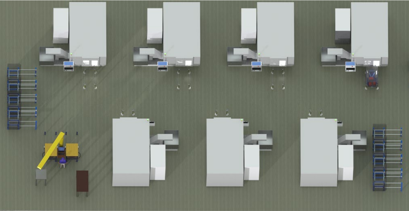
Abbildung 1: Zukünftiger CNC-Maschinenpark zum Designfräsen von Kokillen für die Felgenproduktion
