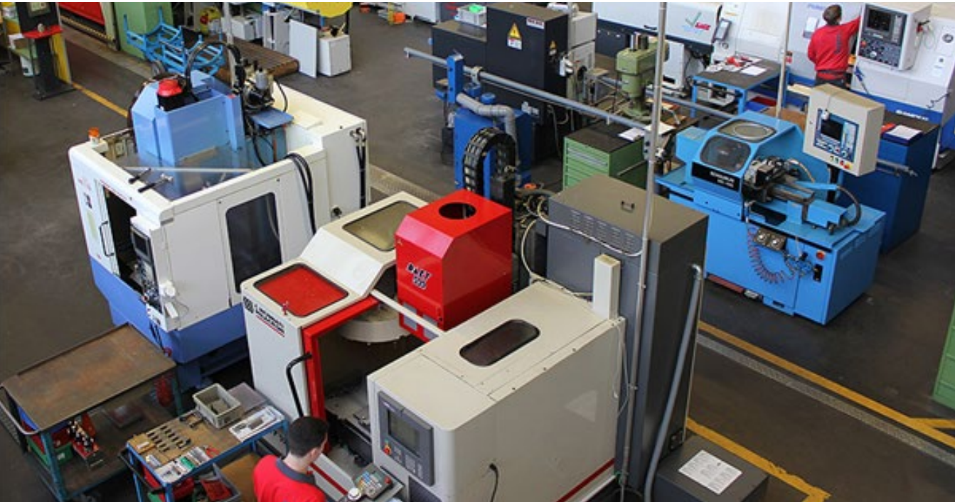
Abb. 1: Mechanische Bearbeitung, rotative und kubische Werkzeugmaschinen für die Herstellung hochpräziser Einzel- und Serienbauteile.
