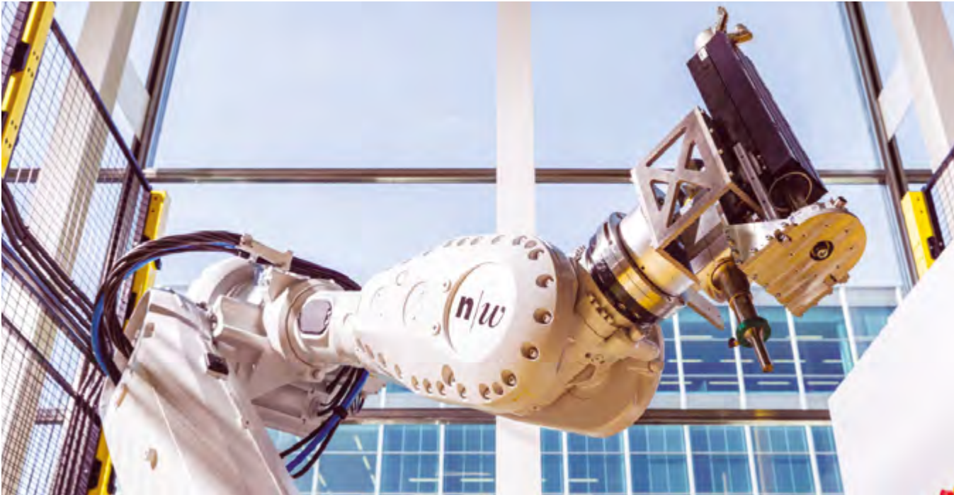
Abbildung 1: Roboter mit Ultraschall-Schweisswerkzeug
