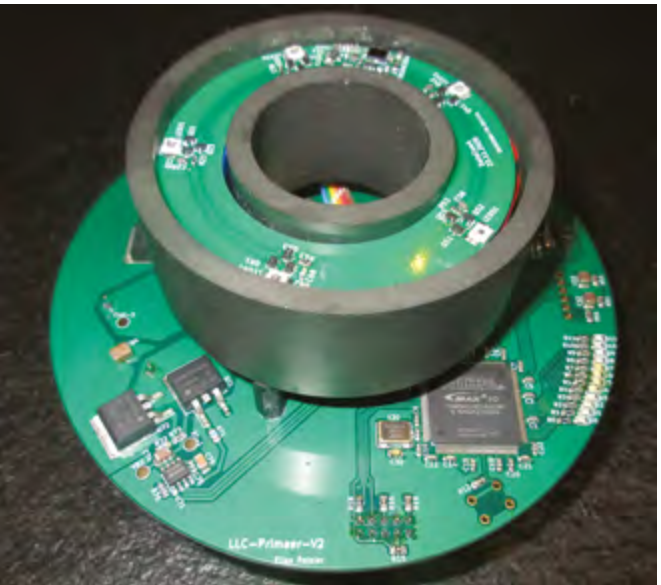
Abbildung 3: Berührungslose Energie- und Datenübertragungseinheit
