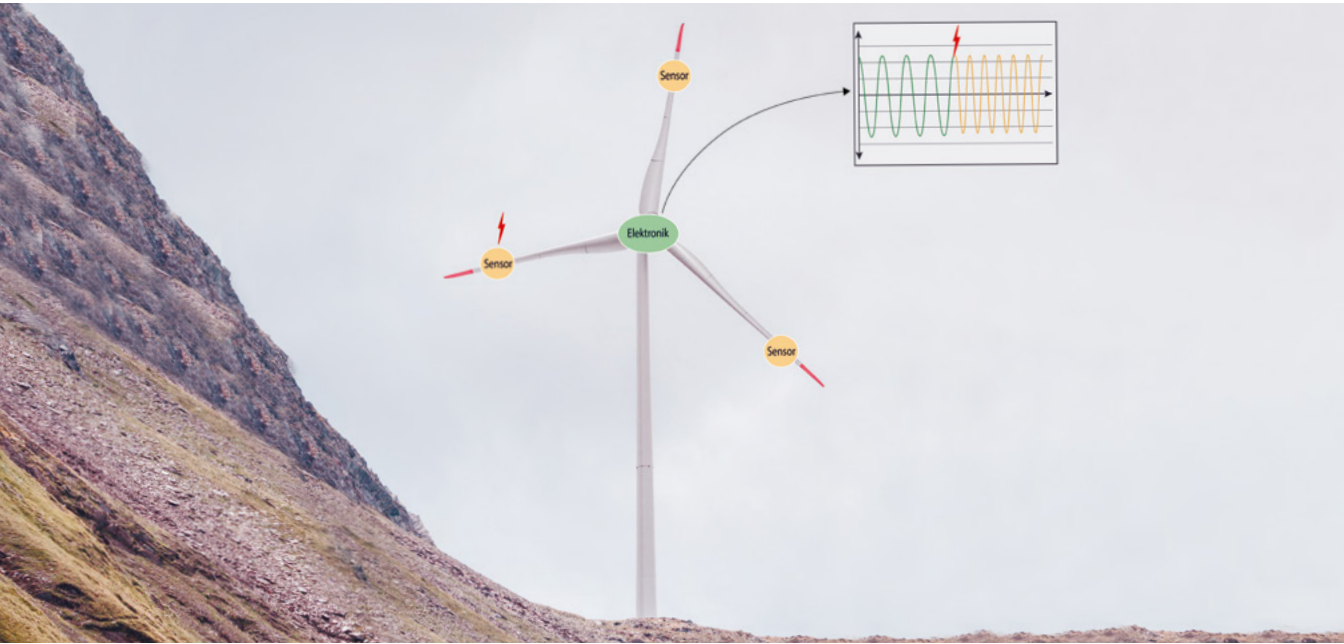
Abbildung 1: Möglicher Einsatzzweck der Sensoren und der Auswertelektronik. Durch einen Blitzeinschlag wurde die Eigenfrequenz des Rotorblatts verändert.
