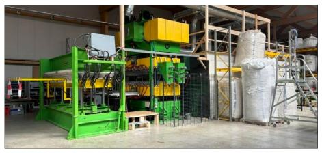
Fertigungsanlage für Sandwichplatten
