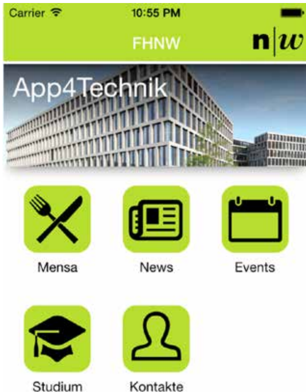
Abbildung 4: Launcher Screen auf der mobilen App mit fünf Modulen. Ein Modul entspricht einem Microservice. Das Modul wird über ein Icon repräsentiert, das vom Microservice bereitgestellt wird.
