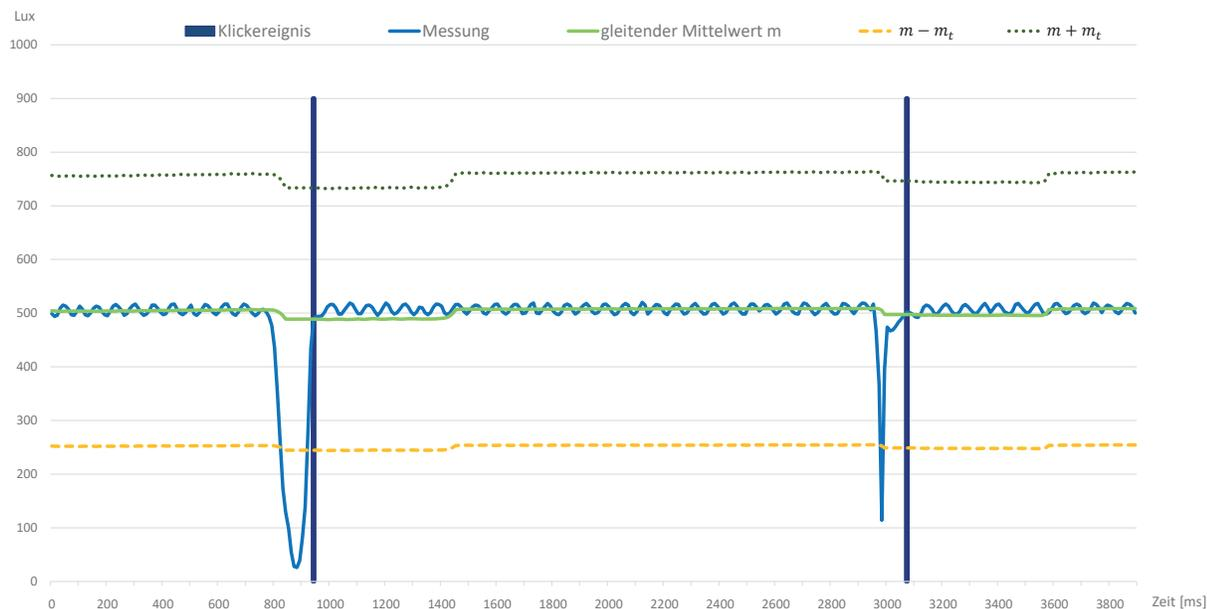
Abbildung 3: Lichtmessungen im Schaufenster. Die beiden senkrechten Balken zeigen ausgelöste Ereignisse an.
