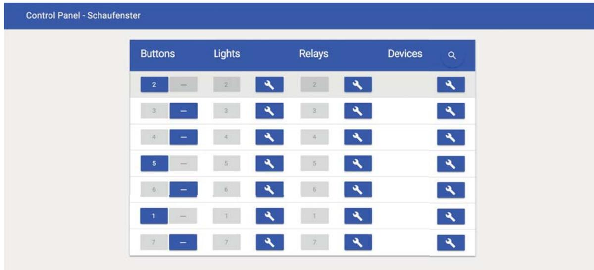
Abbildung 5: Web-App zur Konfiguration: Lampen, Relais und Geräte können mit Schaltern (IoT-Button) verknüpft werden
