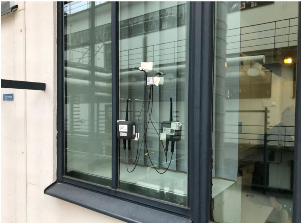
Abbildung 8: Aufbau GreenTEG U-Wertmessung der Verglasung Roche Bau 29 1. OG als Beispiel (INEB)
