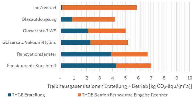
Abbildung 61: Treibhausgasemissionen Erstellung und Betrieb der betrachteten Fenster pro Quadratmeter Bauteilfläche und Jahr für verschiedene Ertüchtigungsvarianten bei der Wärmeversorgung mit Fernwärme (Basel-Stadt)
