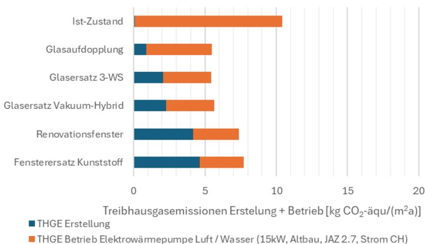
Figure S4: Émissions de gaz à effet de serre pour la construction et l'exploitation d'une fenêtre standard (à deux vantaux, dimensions intérieures du mur 1,55 m x 1,15 m) par mètre carré de surface d'élément de construction et par an, pour différentes variantes d'amélioration, approvisionnement en chaleur au moyen d'une pompe à chaleur air-eau.
