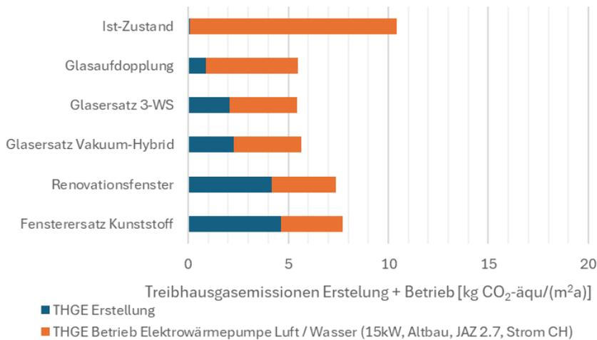
Abbildung S4: Treibhausgasemissionen Erstellung und Betrieb für ein Normfenster (zweiflügelig, Mauerlichtmass 1.55 m x 1.15 m) pro Quadratmeter Bauteilfläche und Jahr für verschiedene Ertüchtigungsvarianten, Wärmeversorgung mittels Luft-Wasser-Wärmepumpe.
