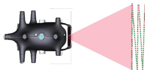
Abb. 2: Flying-Dot-Technologie LAS-20-8 mit interpolierten Punkten (grün); (Leica, 2016)
