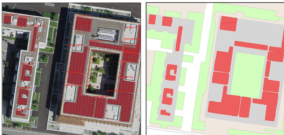
*Abb. 1 & 2: links: Detektierte Solaranlagen, rechts: Umwandlung vom Raster zu Polygonen im GIS*
