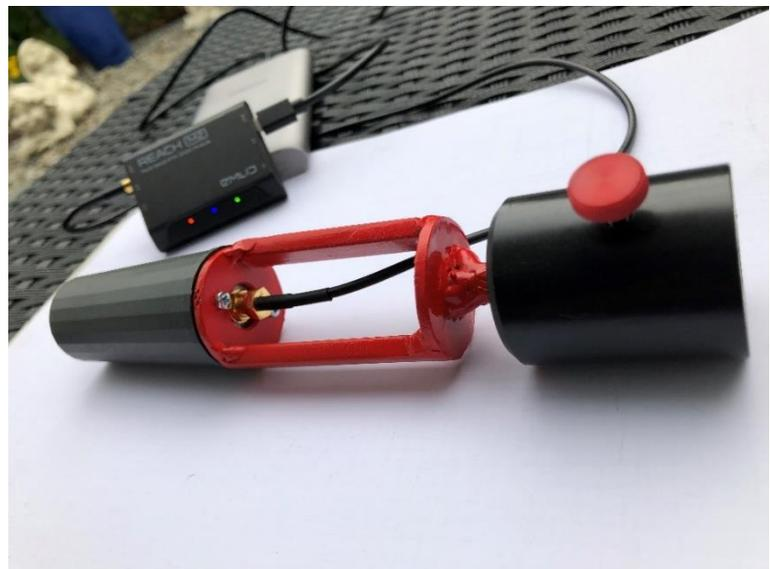
Abbildung 1: Der Emlid Reach M2 im Hintergrund und die Antenne auf dem selbstgemachten Adapter im Vordergrund (eigenes Bild).
