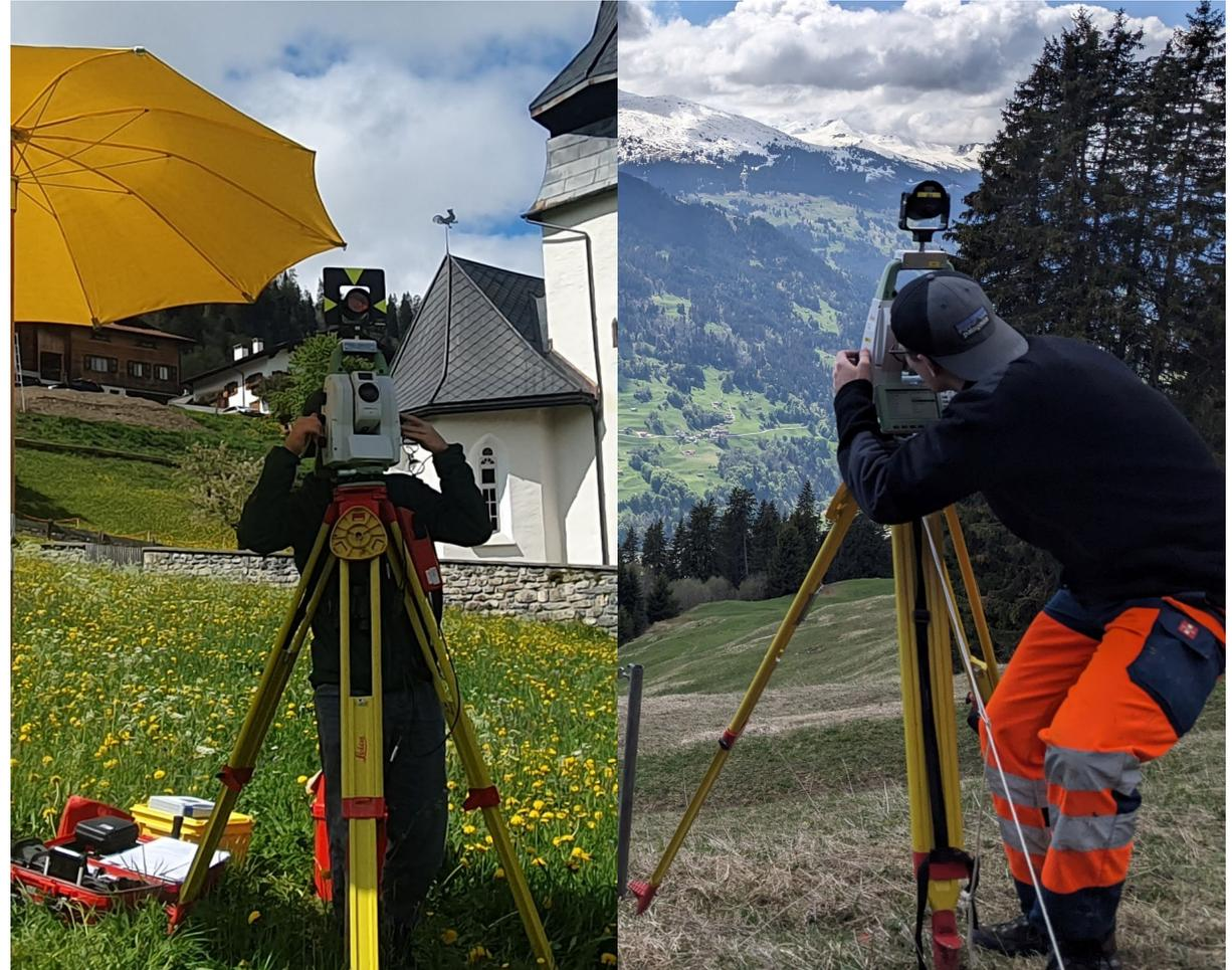
Abb. 5: Gegenseitig & gleichzeitige trigonometrische Höhenbestimmung von der Kirche Conters zur Alp «Boden». (Bild: Peter Mahler und Stefan Sidler)
