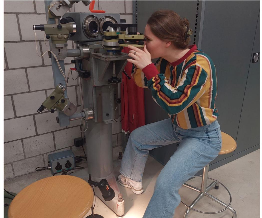
Abb. 3: Studentin Nadia Baumann bei der Kontrolle und Justierung der optischen Lote der DreifüÙe
