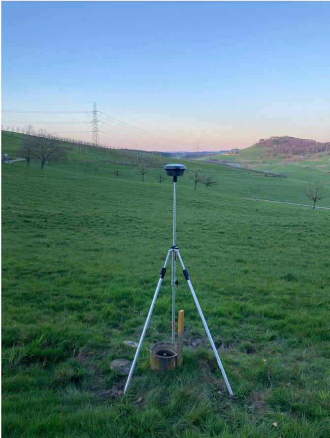
Abb. 5: GNSS-Messung bei Überwachungspunkt 1106
