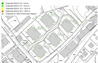
Abb. 7: Planausschnitt der Genauigkeitsuntersuchung von photogrammetrischen Aufnahmen
