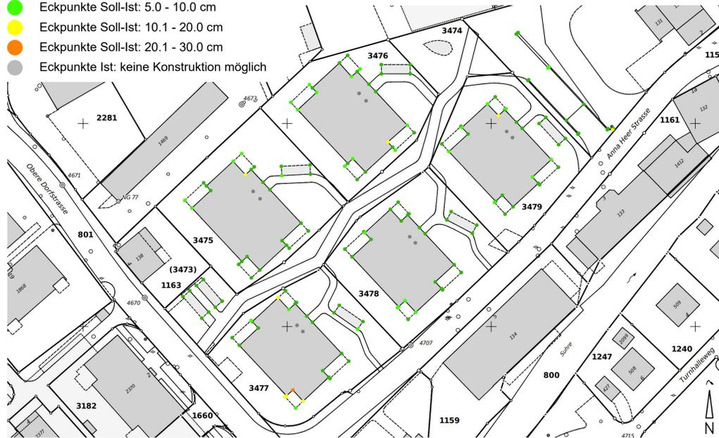
Abb. 7: Planausschnitt der Genauigkeitsuntersuchung von photogrammetrischen Aufnahmen.
