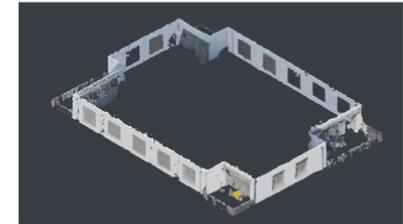
Abb. 6: Konstruktionsarbeiten aus einer Punktwolke
