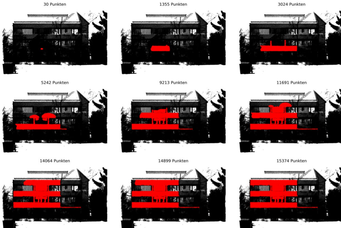
Abb. 5 | Funktionsprinzip der Region-Growing-Methode, Punkte der aktuellen Region (rot)
