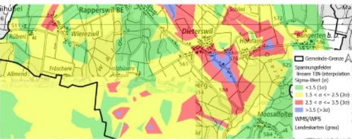
Abb. 4: Spannungsfelder mit der linearen TIN-Interpolation und dem Sigma-Wert aus Abb. 1. Farbe gibt Grösse der Spannung an (siehe Legende).
