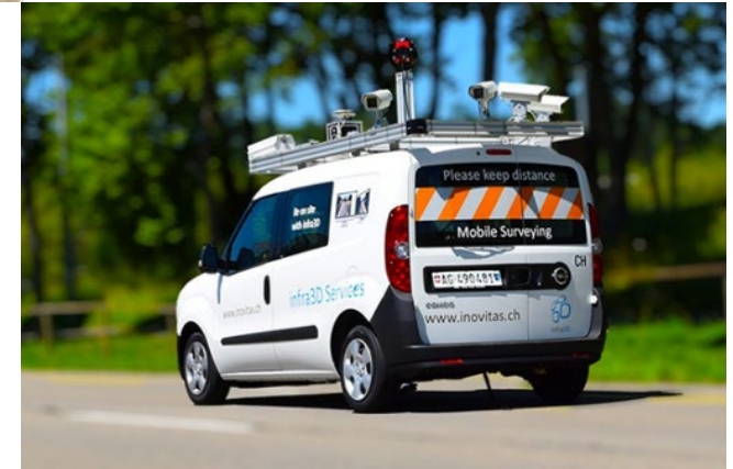
Abb. 2: Ein Fahrzeug der Firma iNovitas zur Erfassung von Strassenbildern. (iNovitas 2022)
