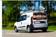
Abb. 2: Ein Fahrzeug der Firma Infra3D zur Erfassung von Strassenbildern. (Infra3D 2022)
