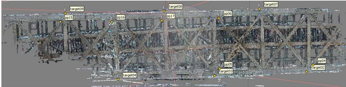
Abb. 8: Das Modell der Brücke ist aufgrund von grob falsch positionierten Bildern fehlerhaft.
