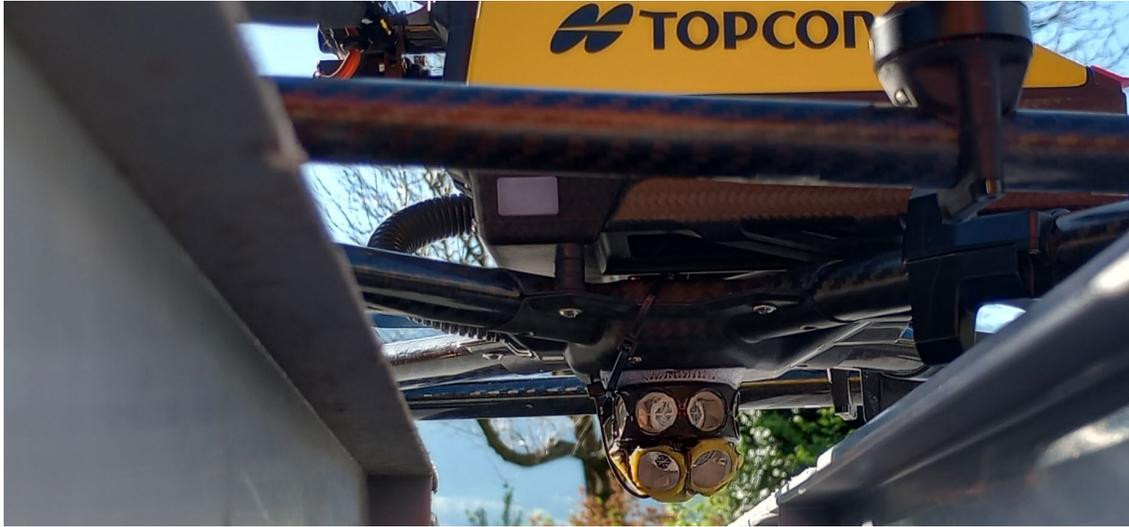
Abb. 10: Das angefertigte Prisma ist von allen Seiten messbar.
