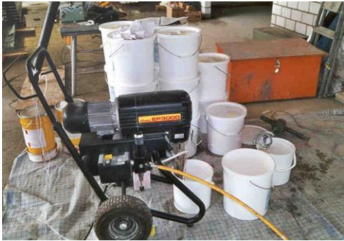
Applikation mit leistungsfähigem Kolbenpumpen-Airless-Spritzgerät
