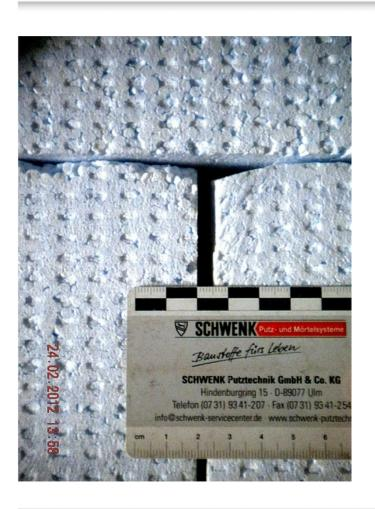
Dämmplatten üben zusätzlich die Funktion der dampfbremsenden, diffusionsbegrenzenden Schicht aus...
