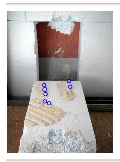
Anteil der effektiven Klebflächen (Kontaktflächen) am Beton
